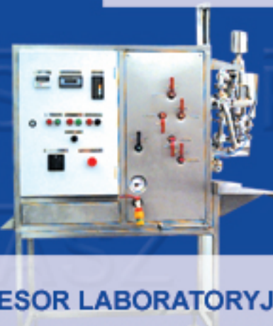
DOZOWNICA TŁOKOWA PISTON DOSER ПОРШНЕВОЙ ДОЗАТОР
